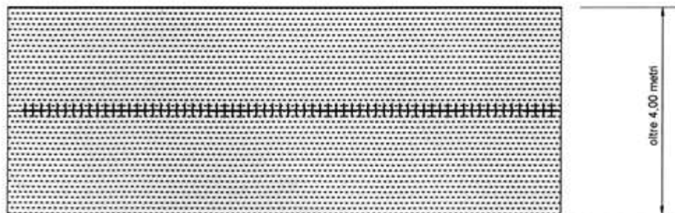
figura 14 scavo al centro della strada
